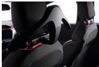
FlexConnect moduláris csatlakozó és vállfa
