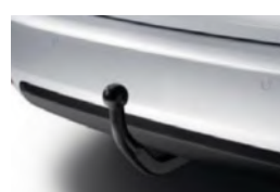
Szerszám nélkül leszerelhető vonóhorog 13 pólusú csatlakozóval
