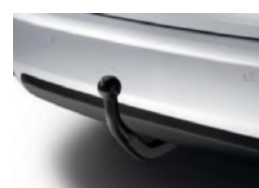
Szerszám nélkül leszerelhető vonóhorog 13 pólusú csatlakozóval
