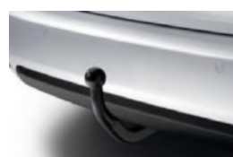
Szerszám nélkül leszerelhető vonóhorog 13 pólusú csatlakozóval
