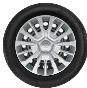
16" acél keréktárcsák, díztárcsával és 205/60 R16 méretű gumiabroncsokkal Alapfelszereltség a Comfort Smart Cargo modelleken
