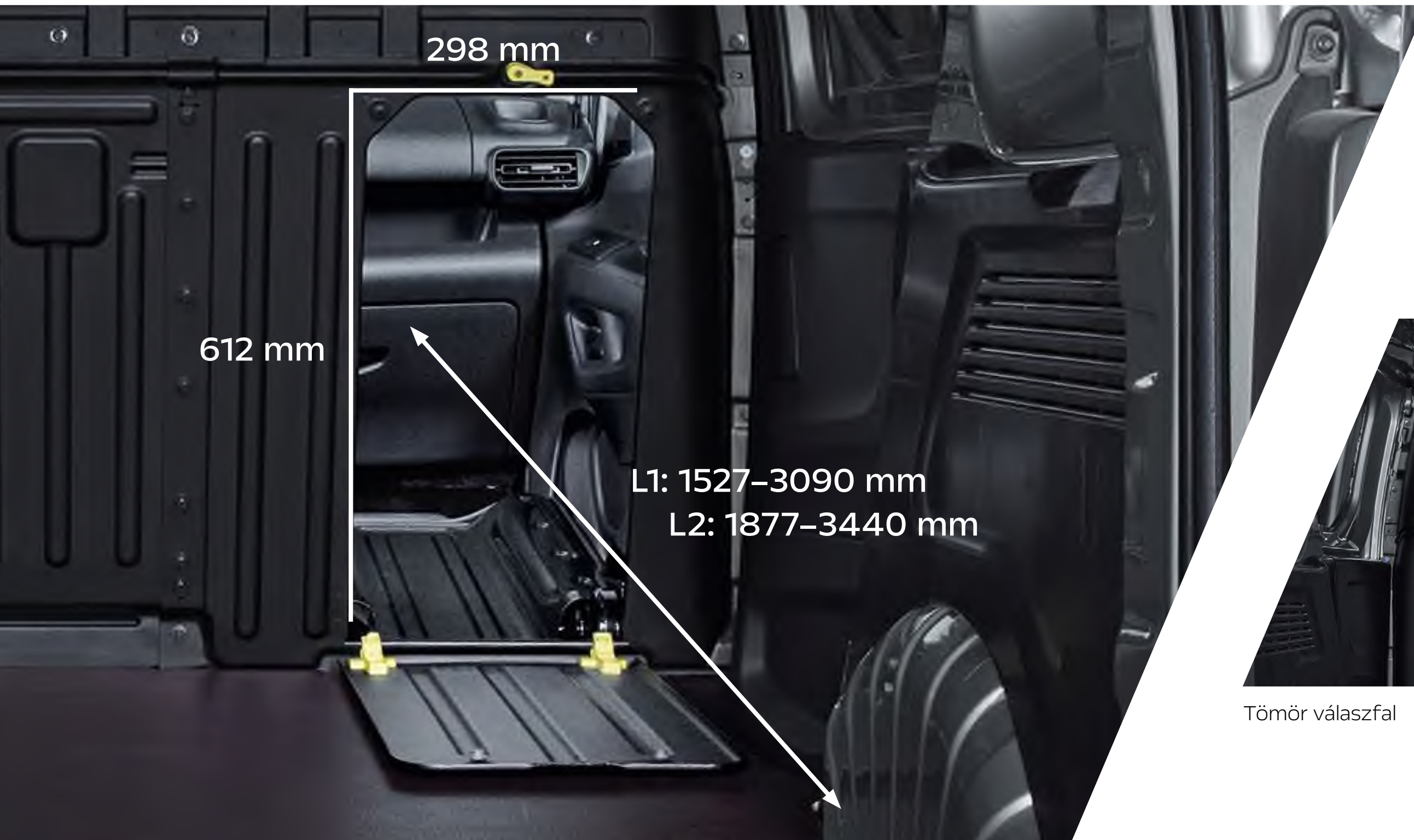
Tömör válaszfal rakodónyílás funkcióval
