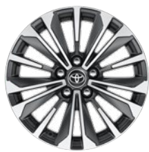
17" könnyűfém keréktárcsák 225/45 R17 gumiabronccsal Alapfelszereltség: Style
