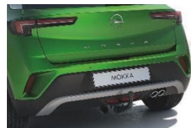
Szerszám nélkül leszerelhető vonóhorog 13 pólusú csatlakozóval
