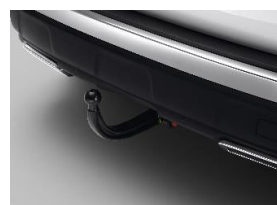
Szerszám nélkül leszerelhető vonóhorog 13 pólusú csatlakozóval
