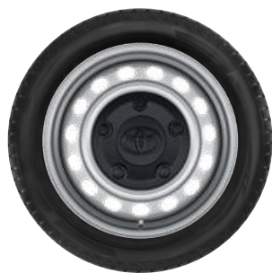
16" acél keréktárcsák 205/60 R16 méretű gumiabroncsokkal
